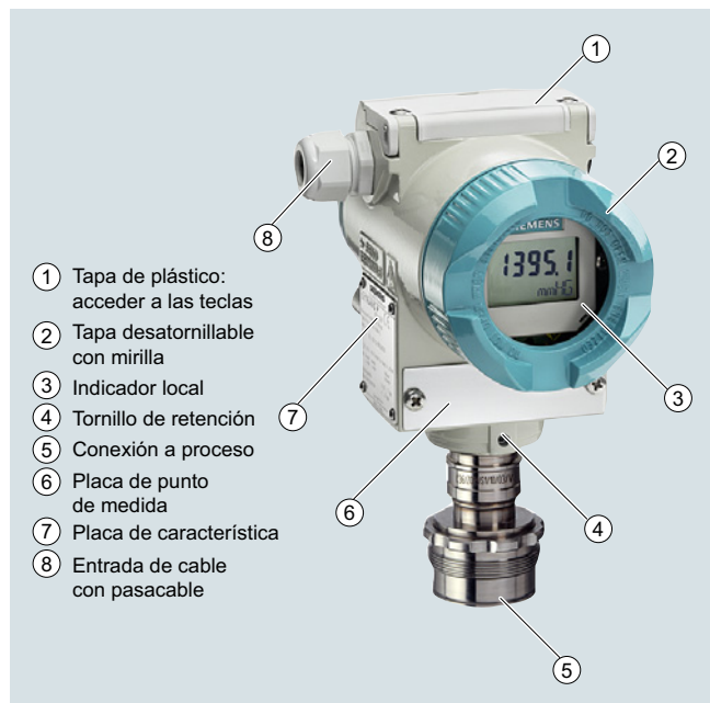
Vista frontal del aparato SITRANS P DS III
